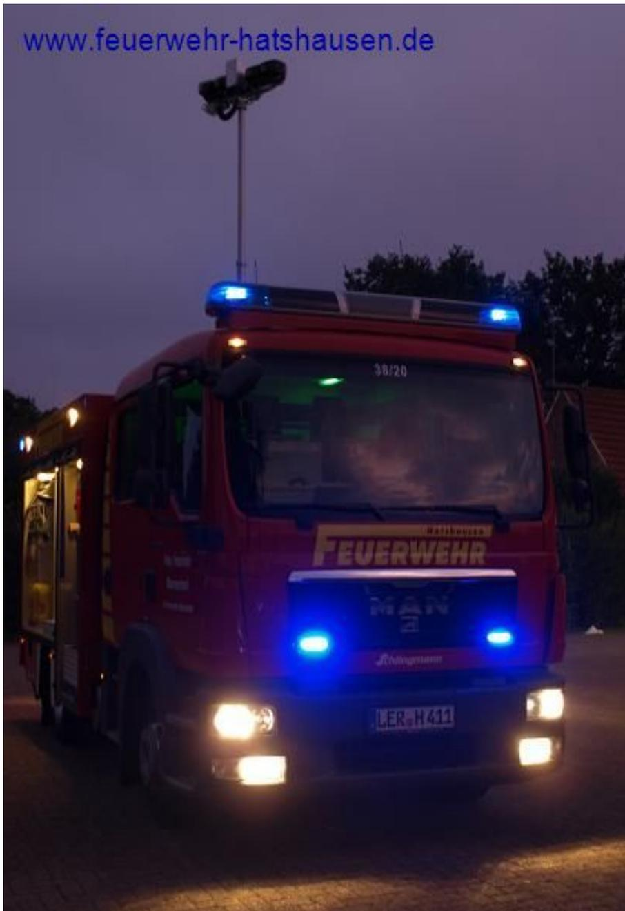
Im Kühlergrill sind, zur Warnung der Verkehrsteilnehmer, zwei Frontblitzer montiert. Zur Straßenabsicherung im Einsatzfall sind am Heck vier orange LED-Blitzer eingebaut und hinten an beiden Seiten befinden sich blaue Heckblitzer. Für die Umfeldbeleuchtung sind über den Gerätenräumen Halogenstrahler montiert. Leuchtstoffröhren sind in den Geräteräumen montiert und sorgen bei Dunkelheit für ausreichend Licht.
